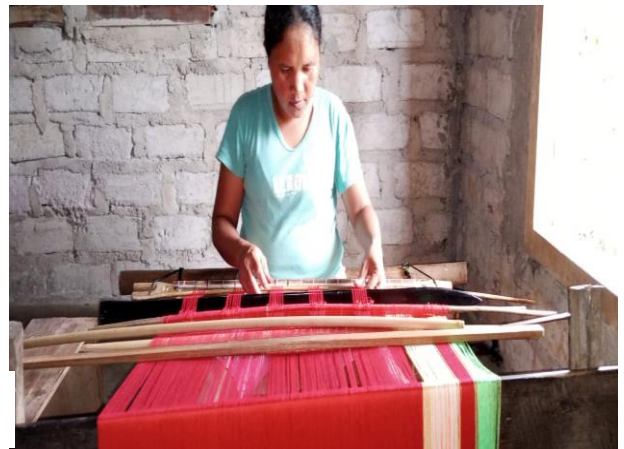
Gambar 1.2 Proses pembuatan kain tenun dengan teknik menenun
